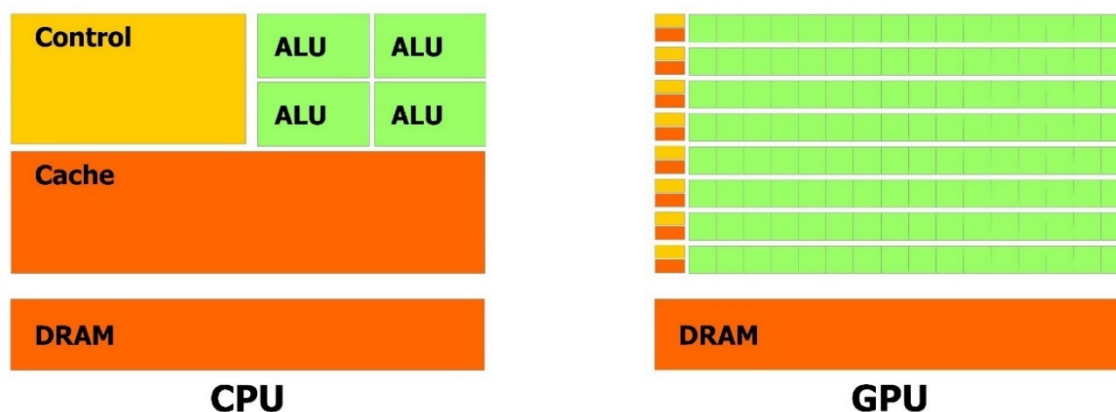
Рис. 6. Сравнение архитектур CPU и GPU
